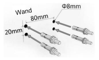
1.4. Nehmen Sie die mitgelieferten Dübel und befestigen Sie diese in den gebohrten Löchern. Lösen Sie danach die Muttern, samt den Unterlegscheiben und Federringen von den Dübeln.
